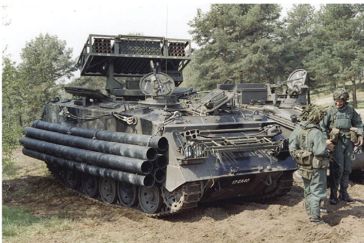
Rys. 3. System inżynieryjny Ranger na podwoziu gąsienicowym [16]
