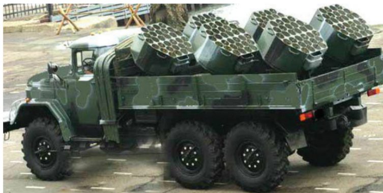
Rys. 5. Naziemny system minowania narzutowego UMZ na pojeździe ZIL-131W [20]
