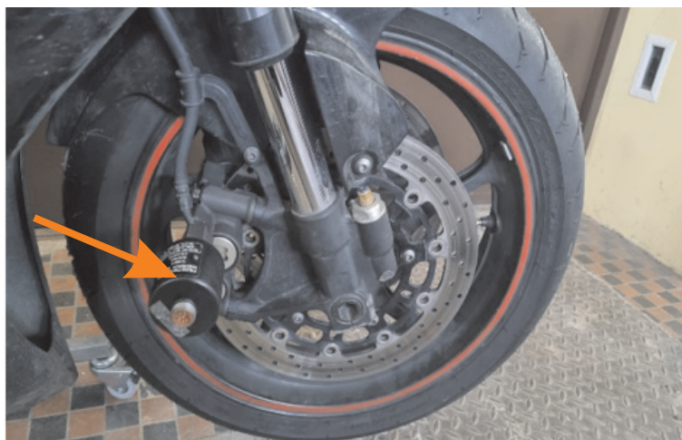
Rys. 1. Widok tensometrycznego czujnika ciśnienia zamontowanego w przednim obwodzie hamulcowym motocykla
