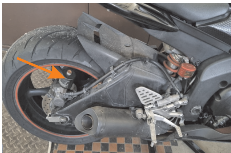
Rys. 2. Widok tensometrycznego czujnika ciśnienia zamontowanego w tylnym obwodzie hamulcowym motocykla
